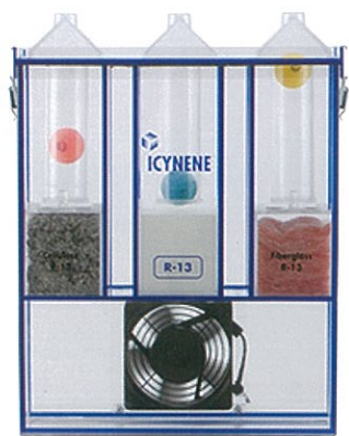
※空気の透過を示す実験 左からセルロース、アイシネン、 グラスウール
