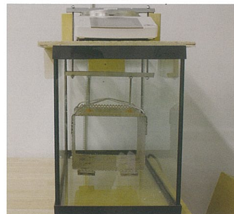
米国ASTMの試験で使用する水中バスケット
